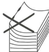
Papier zu dünn – Klammerung trägt auf
