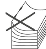
Papier zu dünn – Klammerung trägt auf
