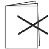
Einlage nicht bündig eingeklebt
